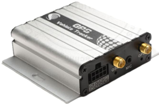
Dispositivo basado en GPRS, GPS incorporado para obtener datos precisos de ubicacion.
